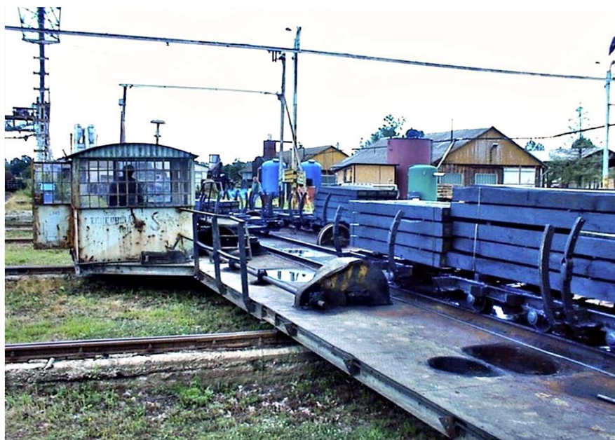
A tolópad szolgált a telítendő és telített anyagok vágányok közötti mozgatására. (Forrás: DRSzN fb. csoport)
