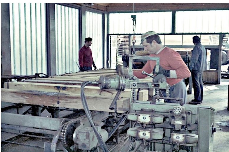
Gebhard István talpfát pántol a hidraulikus pántológéppel.
