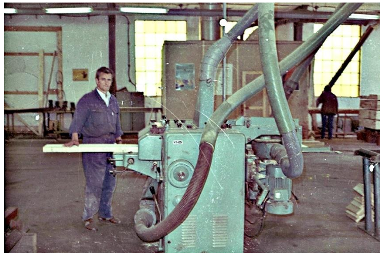
A gyártócsarnokban Horváth György gépkezelő vasúti teherkocsi padlóit készíti négy fejes gyalugépen.
